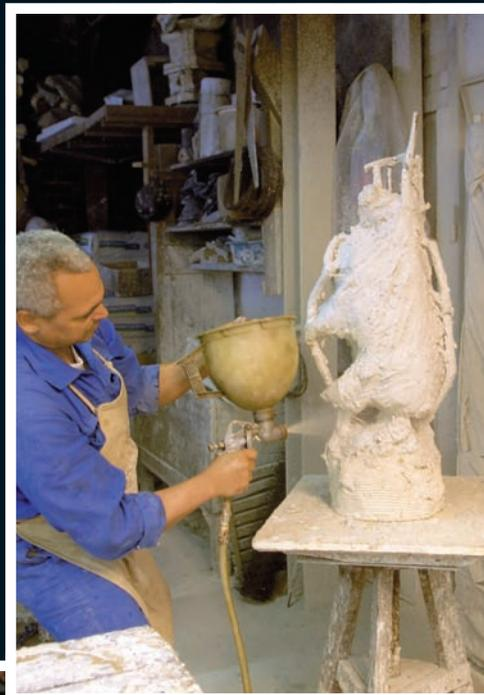
**À l'heure du plâtre.** Minutieusement apprêté, le moule de cire est enduit d'une forte couche de plâtre que l'on consolide de clous pour fixer la structure. C'est cet ensemble que l'on cuira plusieurs heures à 700 ° dans un four pour permettre à la cire d'échapper – d'où le nom de "cire perdue" donnée à cette technique millénaire - et de laisser libre l'empreinte définitive que le bronze remplira lors de la coulée.
